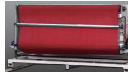
不織布抗沾成型輸送帶，電動昇降與移動設計。
