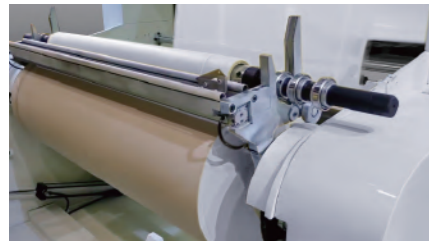
捲取機作計長度自動切布換捲設計，操作方便。
