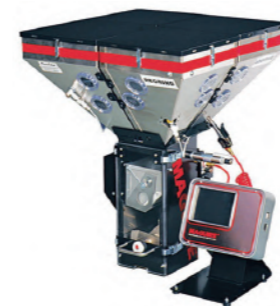
Maguire自動計量混合機(選擇設備)，其功能是按設定原料比例自動精準下料與混合。
